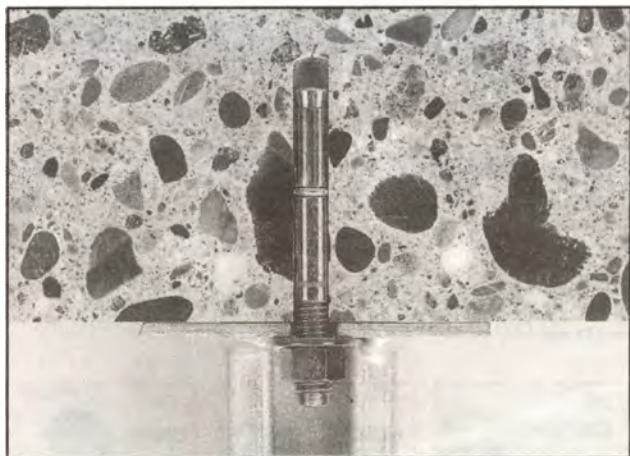
Rögzítés utánterpesztő dübellel mennyezetben
